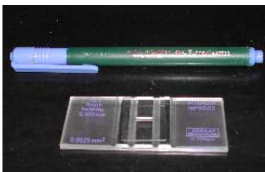
**Figura 9** - Câmara de Neubauer (hemocitômetro) usada na contagem celular durante a realização dos experimentos.
