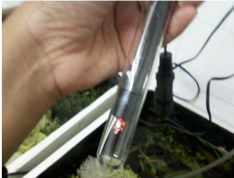
Figura 6: Aquecedores individuais com termostatos colocados nos tanques. Fonte: Arquivo pessoal.
