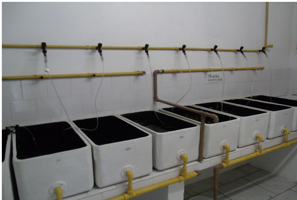
Figura 11: Unidade experimental estruturada com tanques de fibrocimento. Fonte: Arquivo pessoal.
