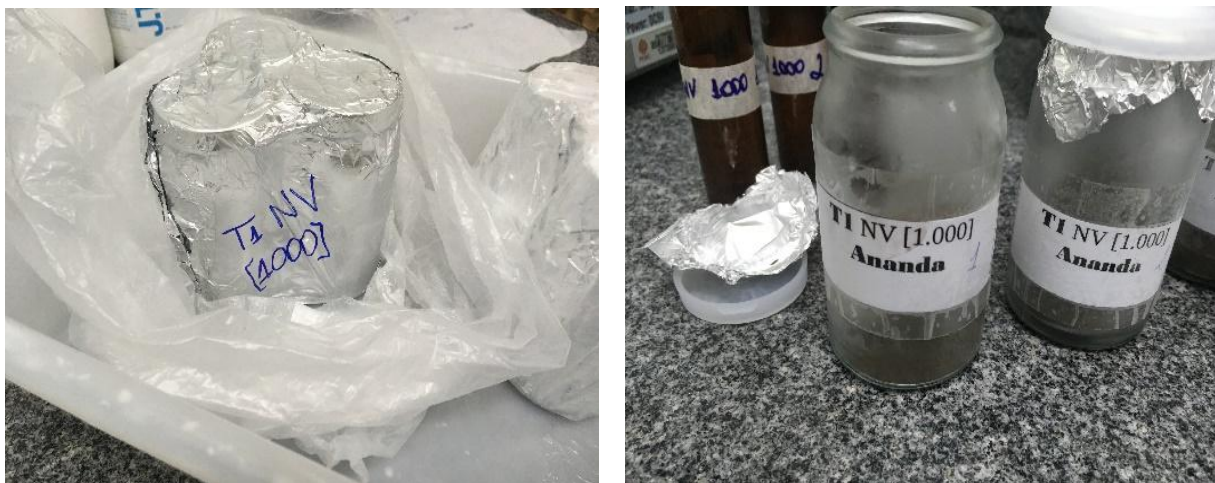
Figura 4. Formas de acondicionamento no freezer das amostras de sedimento fortificadas com TBT.
