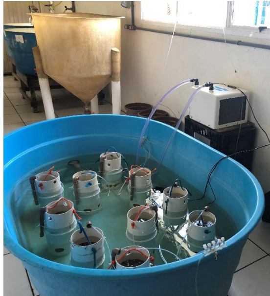
Figura 9: Tanque de manutenção e disposição das unidades experimentais utilizadas nos experimentos de condicionamento do marisco branco ( Amarilladesma mactroides ). A direita da imagem pode se observar o resfriador utilizado para manter a temperatura em torno de em torno de 20,0°C.
