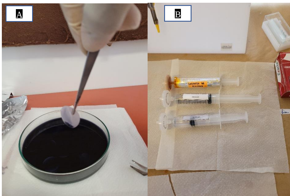
Figura 4 – Placa de Petri com irgalan black para escurecer os filtros (A) e Seringas com laranja de acridina, óleo de imersão e água destilada (B). (Fonte: Hélder Lima)
